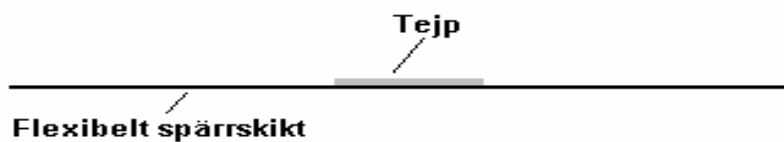
Fig. 4. "Skarv" med tejp för dragprov
